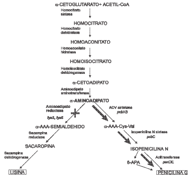
Figura 3. Esquema de las rutas de biosíntesis de penicilina y lisina en P. chrysogenum . Divergencia de dichas rutas a partir del ácido \alpha -aminoadípico.
